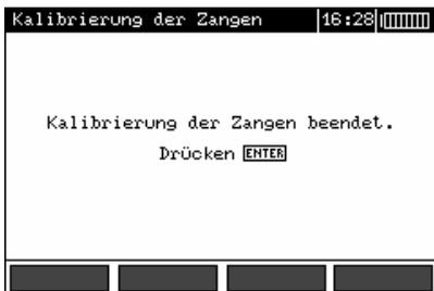
Das Messgerät bestimmt den Korrekturfaktor für die angeschlossenen Zangen. Dieser Faktor wird auch nach dem Ausschalten der Stromversorgung des Messgerätes gespeichert, und zwar bis zur nächsten erfolgreichen Kalibrierung der Zangen.
